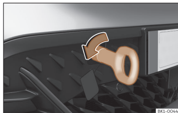
Fig. 168 Paraurti anteriore destro: occhiello di traino avvitato.
