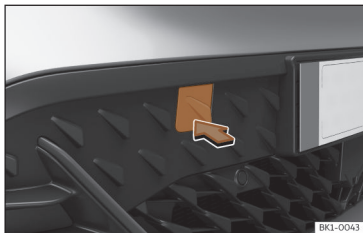
Fig. 167 Sul lato destro del paraurti anteriore: staccare il coperchio.
