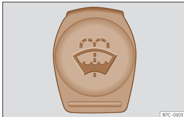
Fig. 178 Nel vano anteriore: tappo blu del serbatoio del tergicristalli.
