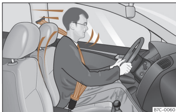
Fig. 16 I conducenti che hanno la cintura di sicurezza correttamente allacciata non saranno proiettati fuori dal veicolo in caso di frenate repentine.
