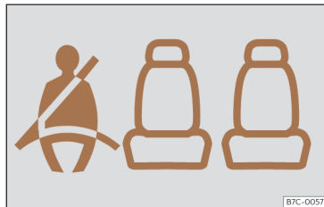
Fig. 17 Quadro strumenti: indicazione dello stato delle cinture di sicurezza delle postazioni posteriori.
