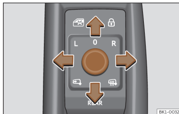
Fig. 94 Particolare della porta del conducente: comandi per gli specchietti retrovisori esterni.
