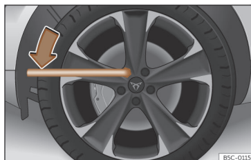
Fig. 184 Cambio di una ruota: come allentare le viti delle ruote.
