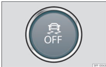
Fig. 177 Nella parte inferiore della console centrale: tasto per attivare/disattivare l'ESC
