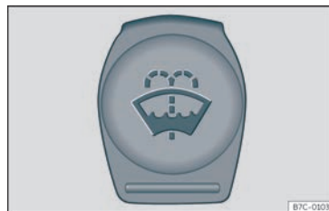
Fig. 209 Nel vano motore: tappo del serbatoio del tergicristalli.
