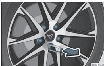
Fig. 35 Ruota: viti della ruota con tappi.
