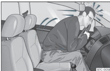
Fig. 7 Il conducente che non indossa la cintura di sicurezza viene scaraventato in avanti
