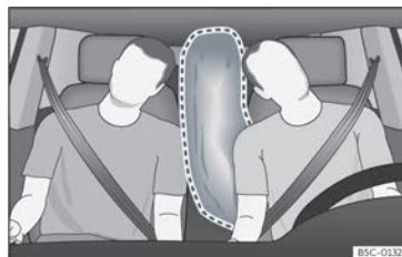
Fig. 20 Airbag centrale completamente gonfiato (area di spiegamento).
