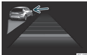
Fig. 161 Sul display del quadro strumenti: ACC attivo, veicolo rilevato sulla sinistra
