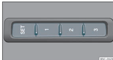
Fig. 104 Sul lato esterno del sedile del conducente: tasti di memoria.
