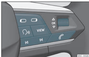
Fig. 60 Lato destro del volante multifunzione: tasti per l'utilizzo dei menu e delle indicazioni informative del quadro strumenti.
