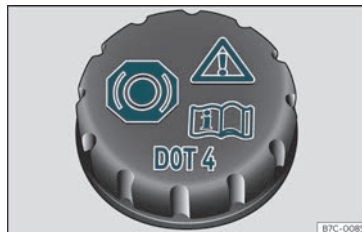
Fig. 208 Vano motore: tappo del serbatoio del liquido dei freni.
