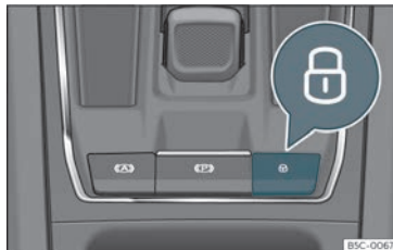
Fig. 75 Sulla console centrale: interruttore della chiusura centralizzata
