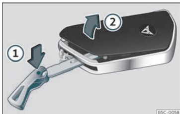
Fig. 72 Chiave del veicolo: aprire il coperchio del vano batteria.
