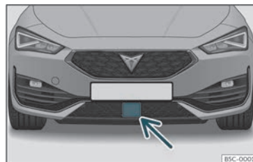
Fig. 148 Sul paraurti anteriore: sensore radar.
