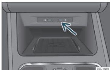
Fig. 140 Console centrale: porta USB.
