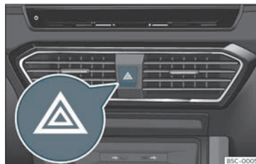
Fig. 91 Cruscotto: interruttore dei lampeggiatori di emergenza.
