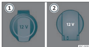
Fig. 129 Presa di corrente da 12 Volt: ① nel bracciolo anteriore, ② nel bagagliaio.
