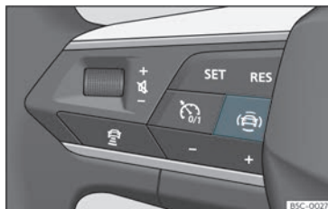
Fig. 62 Lato sinistro del volante multifunzione: chiavi per i sistemi di assistenza alla guida (a seconda delle versioni).
