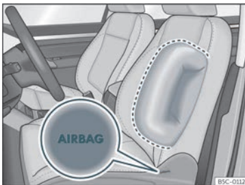
Fig. 21 Airbag laterale all'interno del sedile del conducente.
