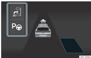
Fig. 178 Sul display del quadro strumenti: visualizzazione dell'assistente al parcheggio con visualizzazione ridotta.
