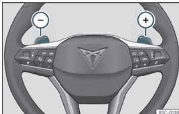
Fig. 146 Volante: leve per il cambio automatico.
