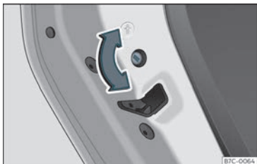
Fig. 80 Sicura per bambini della porta sinistra.
