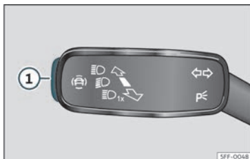
Fig. 61 Sulla leva degli indicatori di direzione e degli abbaglianti: chiave per i sistemi di assistenza alla guida (a seconda delle versioni).
