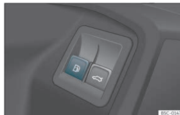
Fig. 198 Porta del conducente: sblocco dello sportellino del serbatoio.
