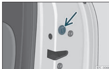
Fig. 79 Blocco di emergenza della porta.
