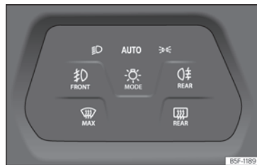
Fig. 89 Cruscotto: interruttore delle luci.
