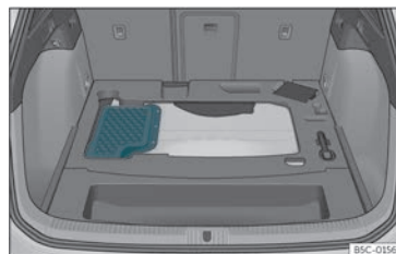
Fig. 211 Alloggiamento della batteria nel bagagliaio
