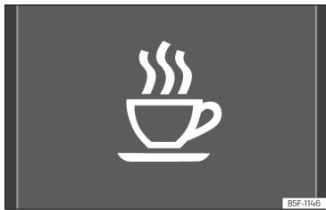
Fig. 53 Sul display del quadro strumenti: simbolo del riconoscimento della stanchezza del conducente.
