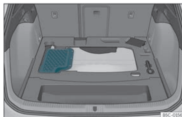
Fig. 222 Alloggiamento della batteria nel bagagliaio
