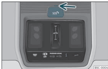
Fig. 36 Nella console del tetto: comandi per i servizi vocali
