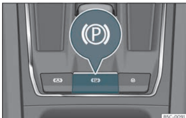
Fig. 186 Nella parte inferiore della console centrale: tasto del freno di stazionamento elettronico.
