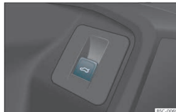
Fig. 87 Sulla porta del conducente: tasto per aprire e chiudere il portellone posteriore.
