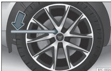
Fig. 41 Cambio di una ruota: allentare le viti della ruota.
