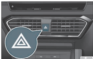
Fig. 96 Cruscotto: interruttore dei lampeggiatori di emergenza.
