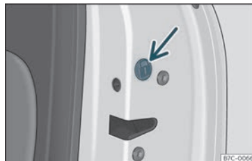
Fig. 83 Blocco di emergenza della porta.
