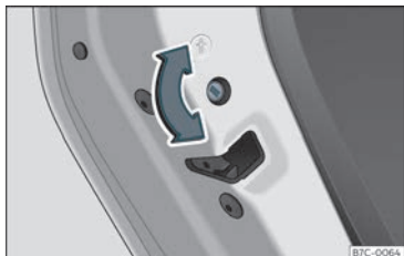
Fig. 84 Sicura per bambini della porta sinistra.
