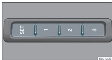
Fig. 106 Sul lato esterno del sedile del conducente: tasti di memoria.
