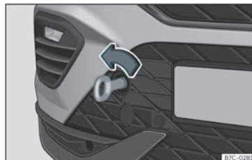
Fig. 42 Sul lato destro del paraurti anteriore: occhiello di traino avvitato.
