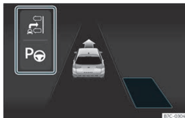
Fig. 178 Sul display del quadro strumenti: vista dell'assistente al parcheggio con visualizzazione ridotta.
