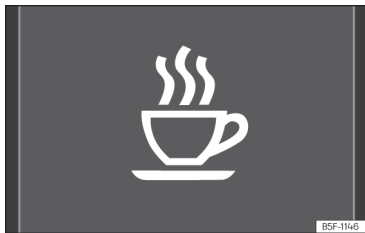
Fig. 58 Sul display del quadro strumenti: simbolo del riconoscimento della stanchezza del conducente.
