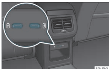
Fig. 138 Parte posteriore della console centrale: Connettori USB con funzione di presa di corrente.
