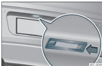
Fig. 53 Nel paraurti posteriore: luce della targa.
