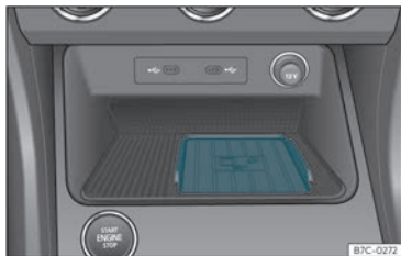
Fig. 136 Sulla console centrale: alloggiamento per il collegamento del telefono cellulare.
