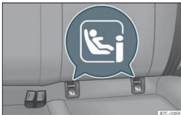
Fig. 25 Sedile posteriore: occhelli di fissaggio ISO-FIX/i-Size.
