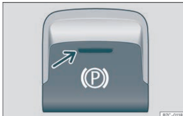
Fig. 175 Nella parte inferiore della console centrale: tasto del freno di stazionamento elettronico.
