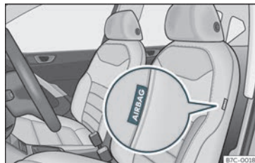
Fig. 19 Airbag laterale all'interno del sedile del conducente.
