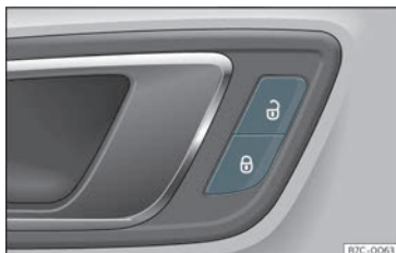
Fig. 75 Porta del conducente: interruttore della chiusura centralizzata.
