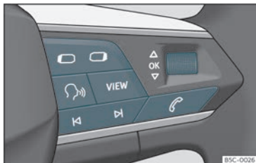
Fig. 62 Lato destro del volante multifunzione: tasti per l'utilizzo dei menu e delle indicazioni informative del quadro strumenti (a seconda della versione).
