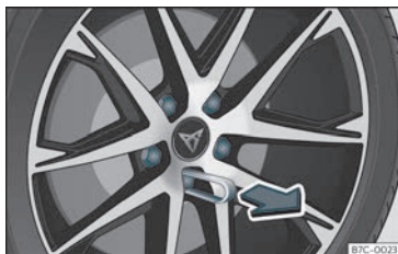
Fig. 32 Ruota: viti della ruota con tappi.
