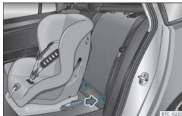
Fig. 26 Sedili posteriori: Posizionamento dei seggiolini per bambini con sistema ISOFIX.
