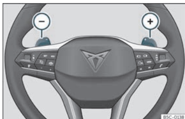
Fig. 144 Volante: leve per il cambio automatico.
