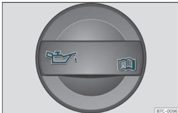
Fig. 203 Vano motore: tappo del bocchettone di rifornimento dell'olio motore.
