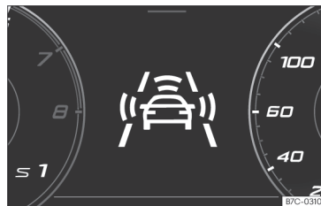
Fig. 158 Sul display del quadro strumenti: indicazioni di preavvertimento.
