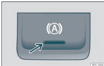
Fig. 176 Nella parte inferiore della console centrale: tasto della funzione Auto Hold.
